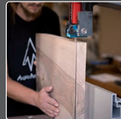
Wysokość cięcia do 346 / 410 mm
