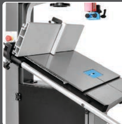
Nachylenie stołu -7^{\circ} - +45^{\circ} / -6^{\circ} - +45^{\circ}
