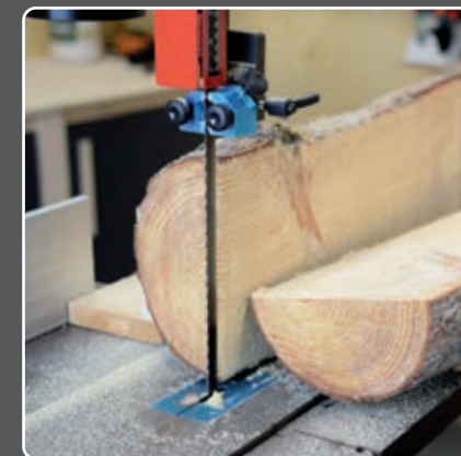
Wysokość cięcia do 305 mm
