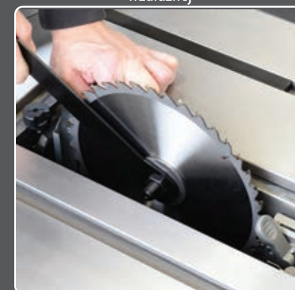
Dźwignia do szybkiej wymiany tarczy
