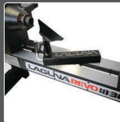
Masywne łożo tokarki o szerokości 208 mm
