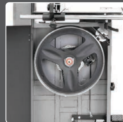
Hamulec tarczowy do szybkiego zatrzymania taśmy
