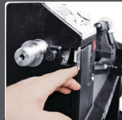
Indeksowanie wrzeciona po 24 punktach
