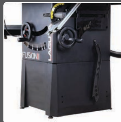
Kontrola nachylenia i wysokości cięcia
